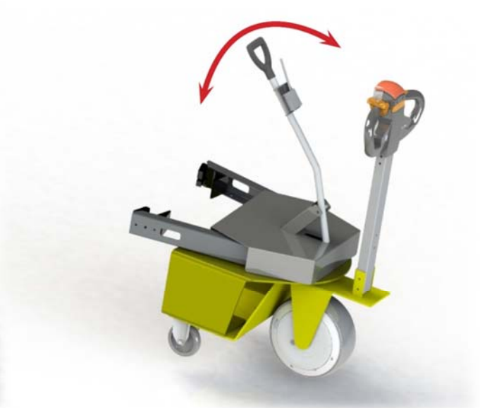
Le levier pilote l'ouverture et la fermeture du système à pinces
